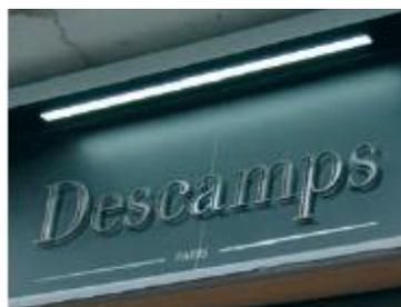
*Rampe LED disposée sous une corniche ou mouleur*
